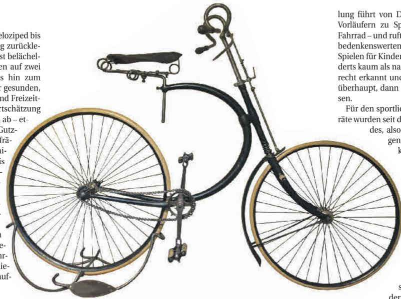
**„Hirondelle“**, ein Sicherheitsniederrad mit halbmondförmigem Rahmen und gedrehtem Lenker sollte aufgrund seiner besonderen Federungseigenschaften überzeugen. Foto: Klaus Reckert
