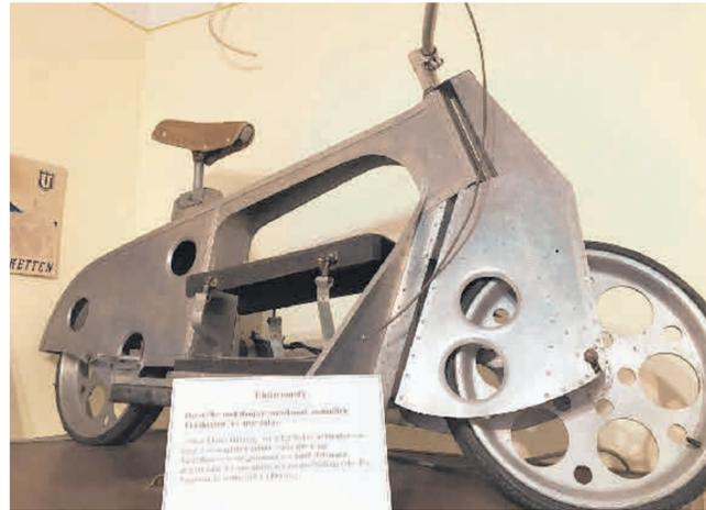
**Elektromofa:** Der vermutlich aus Frankreich stammende Prototyp wurde in Leichtbauweise aus genieteten Aluminiumblechen gefertigt. Foto: Klaus Reckert
