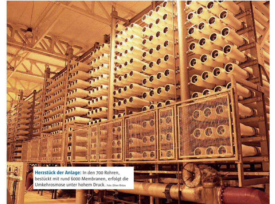
**Herzstück der Anlage:** In den 700 Rohren, bestückt mit rund 6000 Membranen, erfolgt die Umkehrosmose unter hohem Druck. Foto: Oliver Ristau
