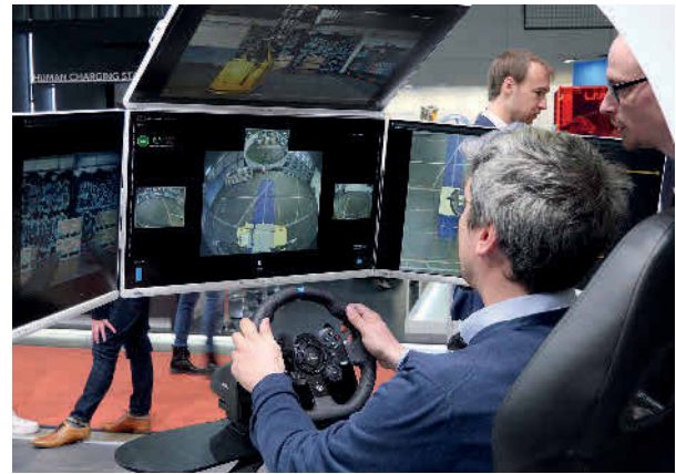
Mit dem Zukunftskonzept des Robot Operations Center (ROC) lässt sich langfristig das Automatisierungspotenzial der Fahrerlosen Transportsysteme (FTS) durch die Kombination von Teleoperation und künstlicher Intelligenz erhöhen. Foto: ek robotics GmbH
