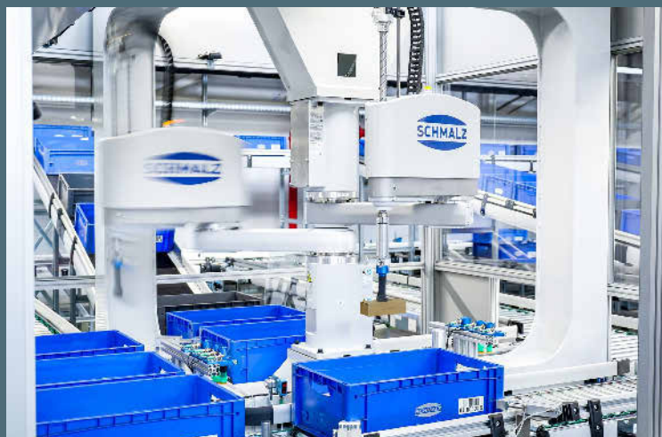
Der Pick Accelerator schafft unter der Führung des Schmalz Solution Kits ivOS Pick-and-Pack 2.700 Picks pro Stunde. Foto: J. Schmalz GmbH
