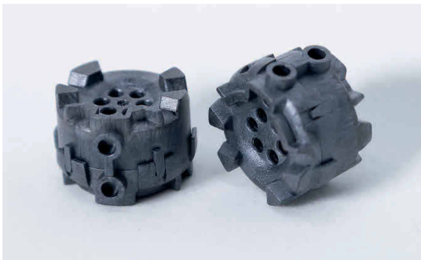
Bild 2: Komplexe Prüfteile: Optisch und elektrisch werden diese Gleichtaktrosseln mit zwei Zentimeter Durchmesser gemessen. Sie dienen der Beseitigung von Störströmen in elektrischen Geräten, konkret in der elektrischen Servolenkung in Fahrzeugen. Foto: Schunk
