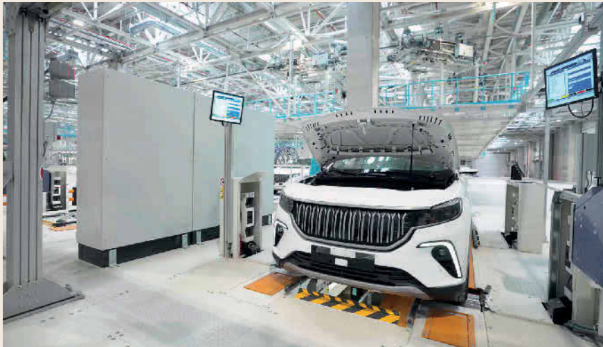
Bild 3 Am Fahrwerkstand x-wheel werden die Fahrzeuge mit Hilfe neuester Sensortechnik geprüft und eingestellt. Foto: Togg
