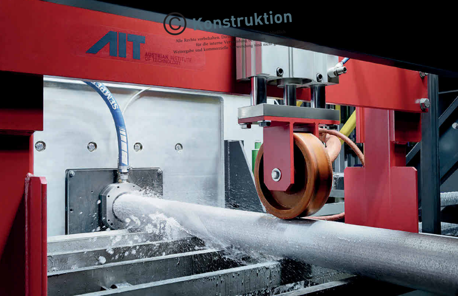
Bild 1 Stranggussanlage am LKR, die im Forschungsprojekt „Digitale Assistenzsysteme zur Prozessoptimierung im Aluminiumstrangguss“ zum Einsatz kommt. Foto: AIT
