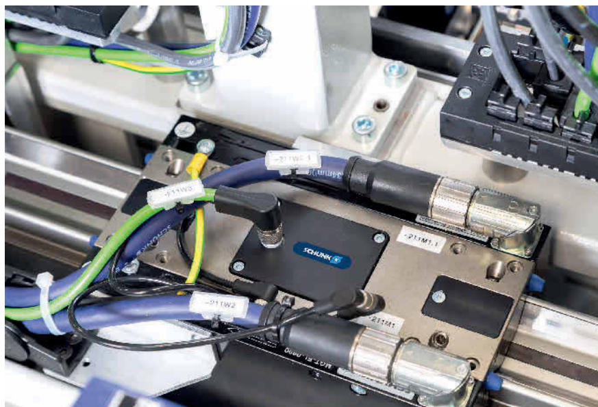
Bild 3: Die universelle Linearachse LDT mit dreifachem X-Profil, Linearmotor und Rollenmotor hat Schunk speziell für diese Anwendung als Sonderlösung mit 2 x 600 N Nennkraft ausgelegt. Foto: Schunk
