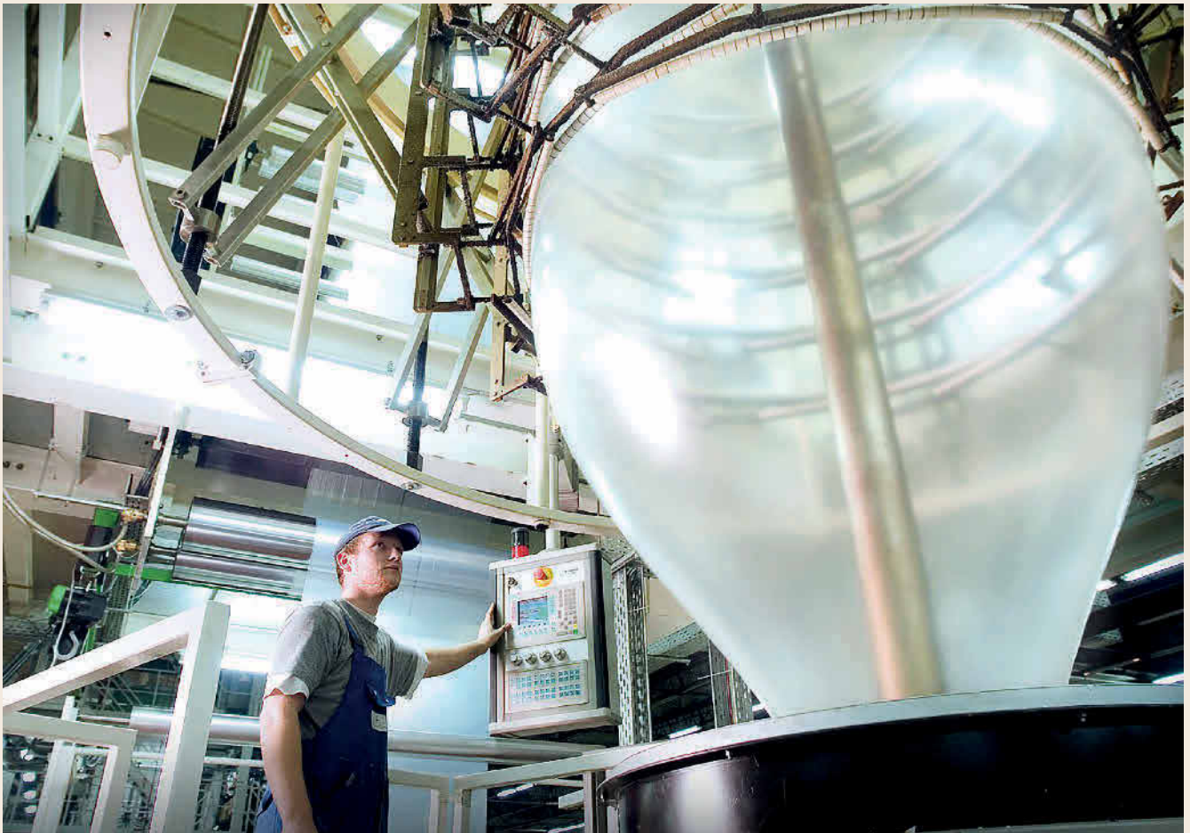
Bild 1 Die im Rahmen des Rubio-Projekts entwickelten Biokunststofffolien aus PBS sind recyclingfähig, biologisch abbaubar und können auf gängigen Extrusionsanlagen verarbeitet werden. Foto: Polifilm
