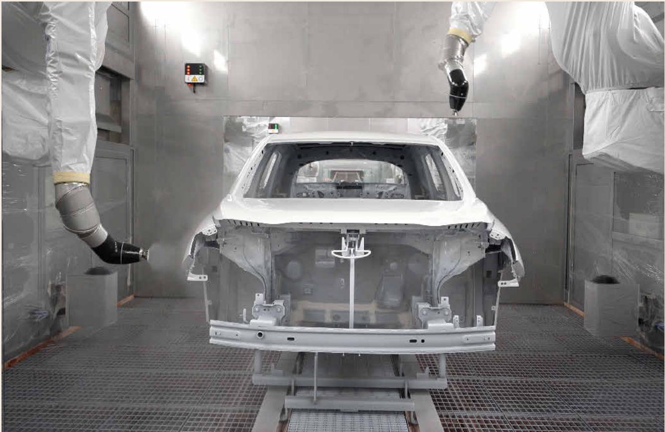
Bild 1 Die sieben-Achs-Lackierroboter EcoRP E043i, ausgestattet mit moderner Applikationstechnik, sorgen für höchste Beschichtungsqualität. Foto: Togg
