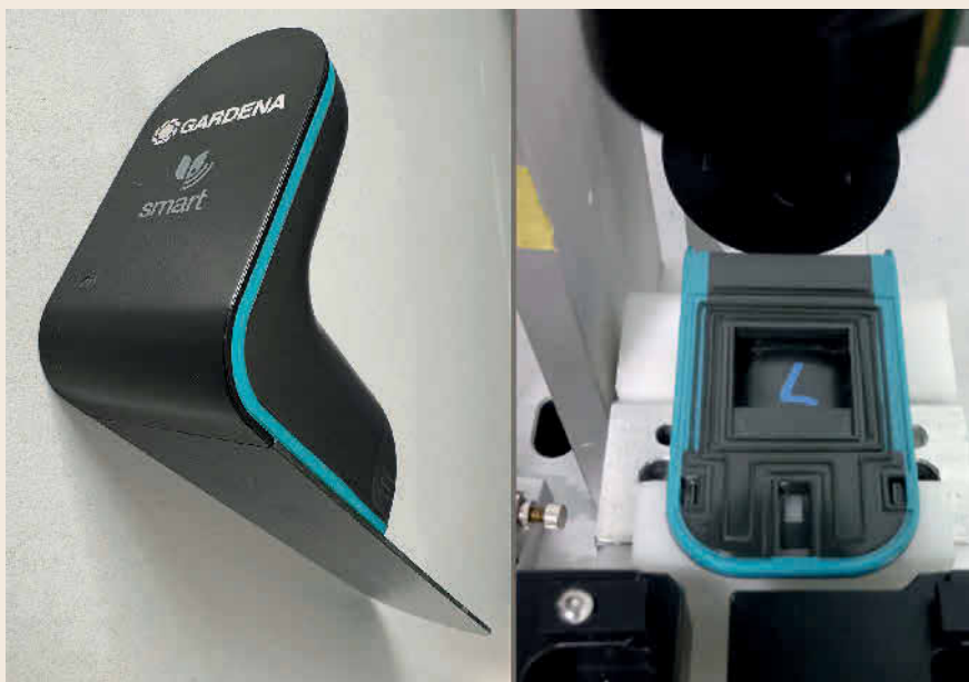
Bild 2 Gardena Smart Sensor inklusive Klebstoffraupe. Das Kunststoffgehäuse, das mit dem Verbundwerkstoff verbunden wird, besteht aus dem thermoplastischen Kunststoff ABS. Beim Kleben der Teile ist es wichtig, dass der verwendete Klebstoff die beiden Materialien absolut dicht und formstabil miteinander verbindet. Foto: Ruderer
