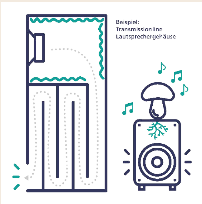
Bild 2 Schematische Darstellung der komplexen Geometrie eines Lautsprechergehäuses mit Transmissionline. Grafik: Fraunhofer IWU
