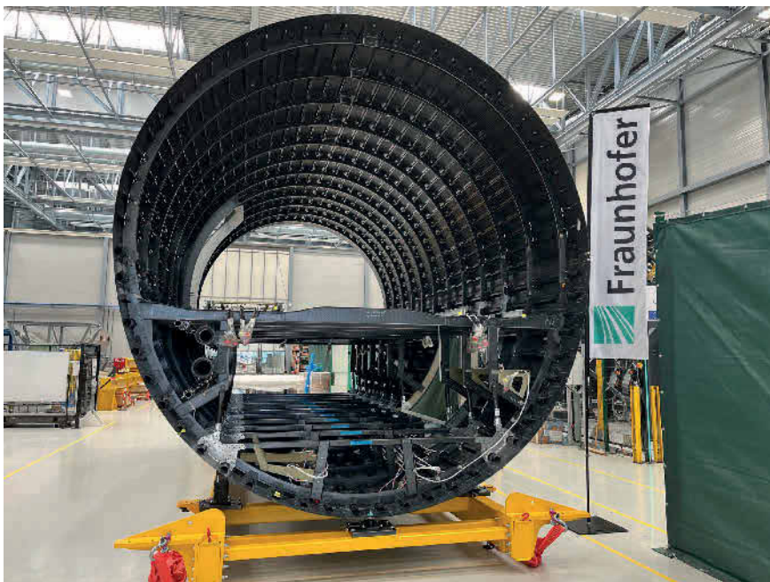
Das durch Thermoplastschweißen fertig gefügte „MFFD“-Flugzeug-Rumpfsegment bei der Fraunhofer-Gesellschaft in Stade. Foto: Fraunhofer IFAM
