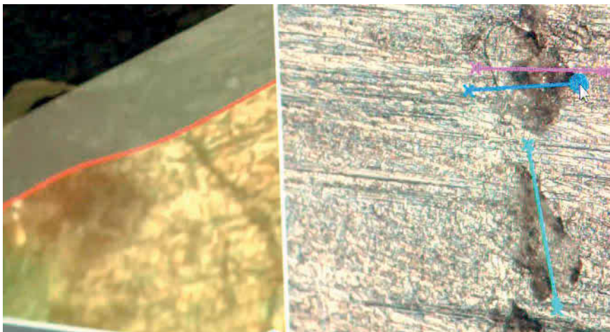
Bild 5: Zeigt sich nach der Validierung noch Optimierungsbedarf, werden die Musterlager aus den getesteten Baugruppen ausgebaut und einer Schadensanalyse nach VDI Richtlinie 3822 unterzogen. Foto: Findling Wälzlager
