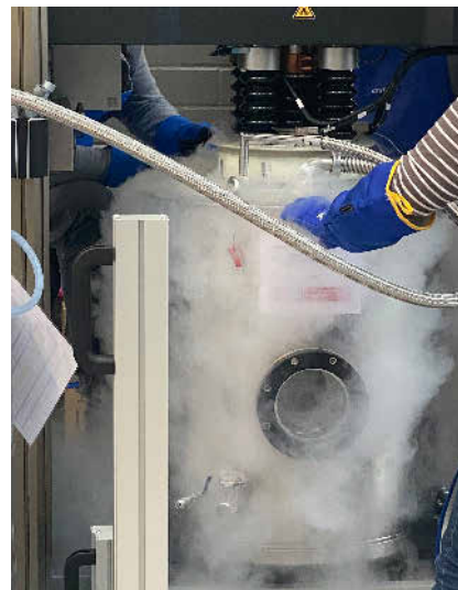
Bild 3: Autoklav mit der zu prüfenden Probe im Innern. Foto: Faserinstitut Bremen e.V. (FIBRE)
