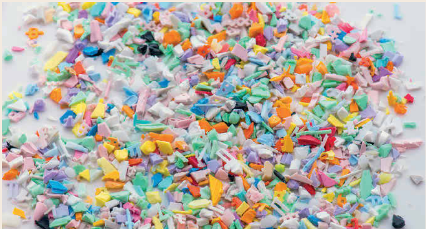
Bild 1 Kunststoffrezyklate sollten verstärkt für die Herstellung neuer Bauteile genutzt werden. Doch wenn es um die Lackierung der so gefertigten Komponenten geht, stehen die Hersteller oft vor Problemen, da die Rezyklate mitunter große Qualitätsschwankungen aufweisen. Foto: PantherMedia / XXLPhoto
