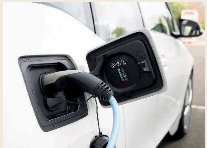
In Kunststoffbauteilen der Ladestecker für E-Autos stecken Flammschutzmittel wie auch in vielen anderen elektronischen Produkten, Textilien oder auch Möbeln. Foto: Fraunhofer Umsicht
