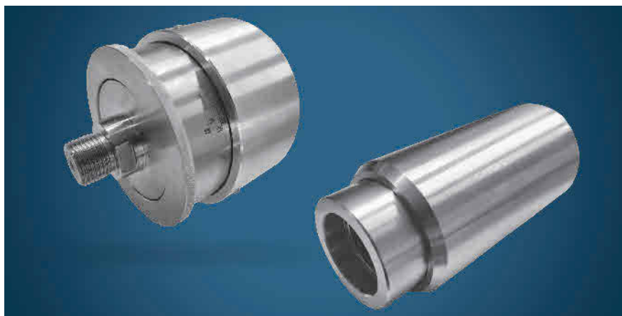
Bild 2: Die Hysteresemagnet-Kupplungen von KBK rutschen im Fall einer Überlast sanft durch. Sie eignen sich damit für den Einsatz an Schraubverschleißern von Getränkeabfüllanlagen oder in Dehnfolien-Verpackungsmaschinen. Foto: KBK Antriebstechnik
