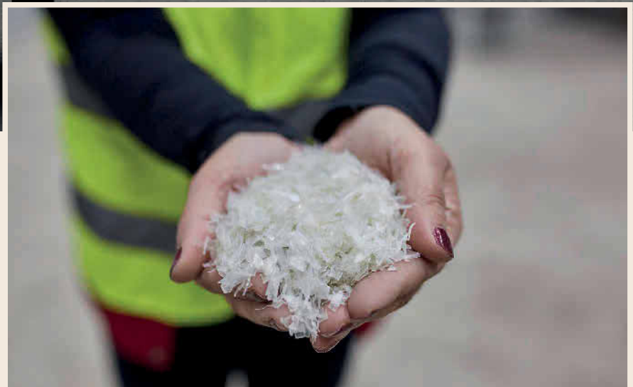
Bild 2 Mit dem sogenannten „advanced mechanical recycling“ von Kunststoffen aus Haushaltsabfällen hat Borealis einen Schritt in Richtung Kreislaufwirtschaft gesetzt und bietet ein Portfolio an PP Compounds mit mehr als 25 Prozent PCR-Anteil an. Foto: Tomra
