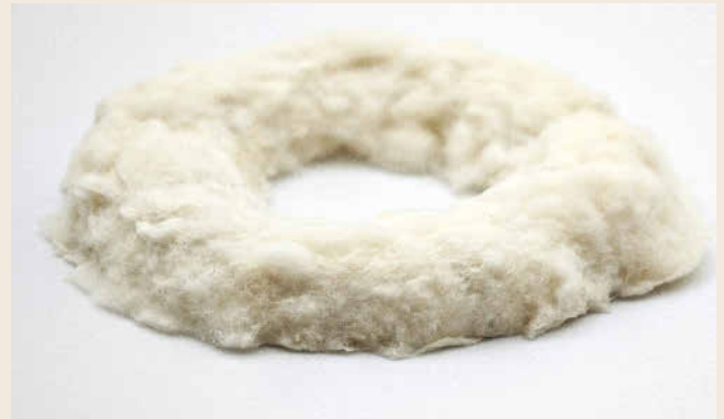
Bild 3 Schaumartige Strukturen absorbieren (schlucken) den Schall und reduzieren unerwünschte Schwingungen. Foto: Fraunhofer IWU
