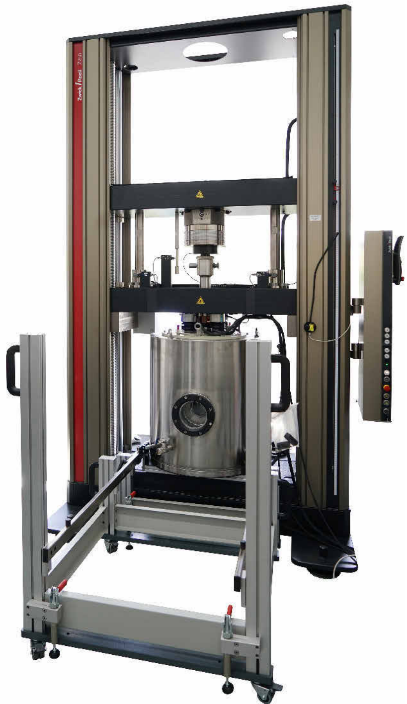
Bild 2: Die Prüflösung ermöglicht eine Vielzahl von Versuchen an Faserverbundwerkstoffen, darunter Zug-, Druck- und Biegeversuche in Flüssig-Stickstoff. Foto: Faserinstitut Bremen e.V. (FIBRE)
