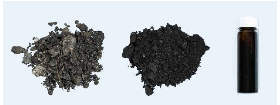
Teer unterschiedlich weit aufbereitet: Links ist das Rohmaterial – unbehandelte teerhaltiger Straßenaufbruch – zu sehen, in der Mitte mit dem Fraunhofer-Verfahren dekontaminiertes Material und rechts Pyrolyseöl aus dem Dekontaminationsprozess. Foto: Fraunhofer Umsicht
