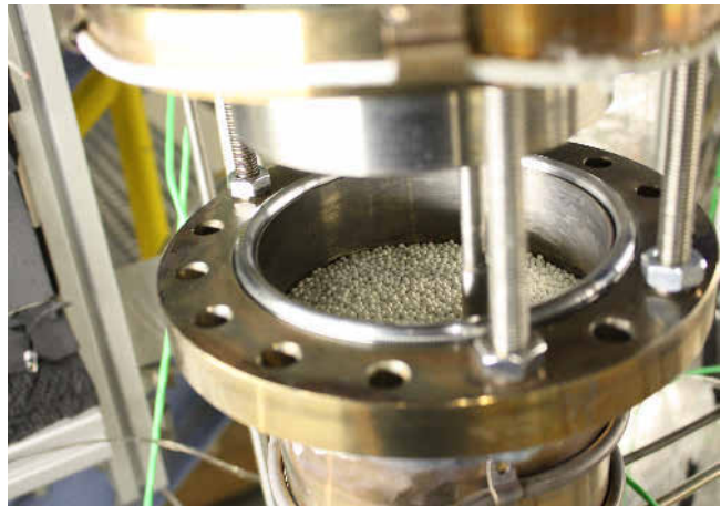
Wärmespeicher im Labormaßstab: Auf dem Foto sind die Keramikkügelchen zu sehen, die die Wärme speichern. Foto: Kalla/KIT
