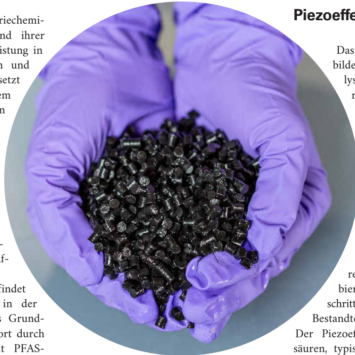
Der Piezokatalysator aus der Schweiz wird in Form von etwa 5 mm großen Zylindern hergestellt. Dies stellt einen tiefen Druckverlust im Reaktorbett, sowie eine einfache Handhabung sicher. Foto: Daniel Kunz/Adliswil
