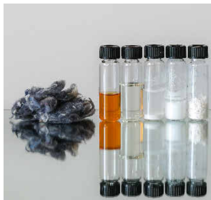
Der Prozess von re.solution : von geschredderten Alttextilien über das Hydrolysat zu kristallisierten Monomeren. Foto: re.solution/Karl Hammer
