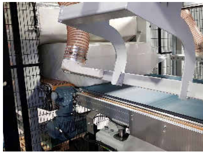
Blick in Getechas Kanisterverpackungsanlage: Die Kanister werden lagenweise eingeschweißt. Die überstehende Folie wird abgeschnitten, anschließend schrumpft die Folie bei bis zu 200 °C. Foto: Getecha
