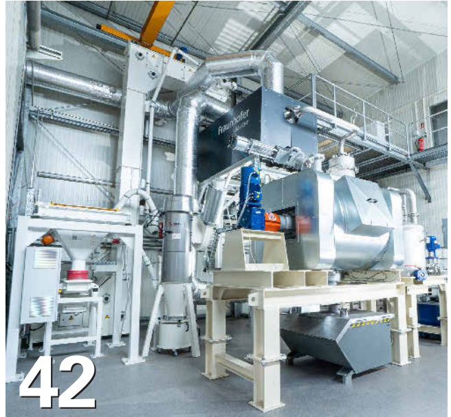
Im Fraunhofer-Projekt „Inno-Teer“ wurde ein neuartiges Aufbereitungsverfahren für teerhaltigen Straßenaufbruch entwickelt, das sich gerade im Demonstrationsmaßstab bewährt. Foto: Fraunhofer Umsicht
