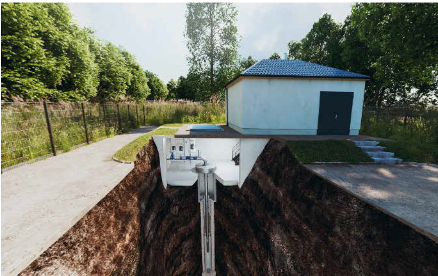
Eine Actun-Zetos-K8-Pumpe, 6,125 m lang, in einer Tiefbrunnenstation eingebracht. Grafik: Wilo
