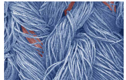
Rasterelektronenmikroskopische Aufnahme: Textilfasern (blau koloriert) und anspruchsvolle elastische Fasern (rot gefärbt) sind mit dem Plasmaverfahren gleichmäßig mit Siloxanen wasserabweisend ausgerüstet. Foto: Empa
