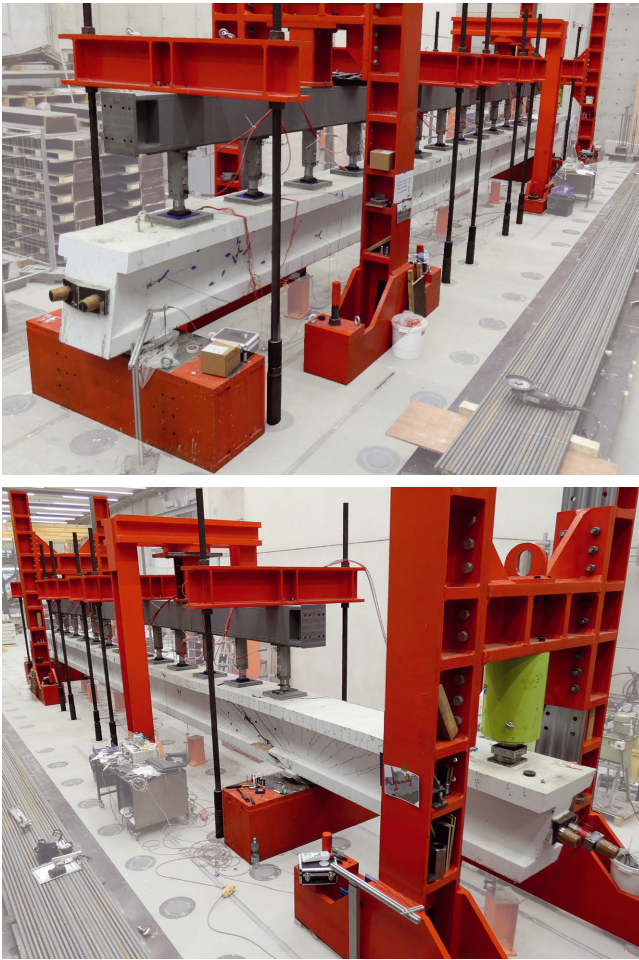
Bild 7. Ansicht des Trägers 3 nach Schubversagen in TV 1; oben: Spananker mit der Streckenlast im 13 m langen Feld; unten: Festanker mit der Einzellast auf der Kragarmspitze Foto: C. Dommès Fig. 7. View of girder 3 after shear failure in the first partial test; top: prestressing anchor with the continuous load in the 13 m field; bottom: fixed anchor with the single load on cantilever Source: C. Dommès
