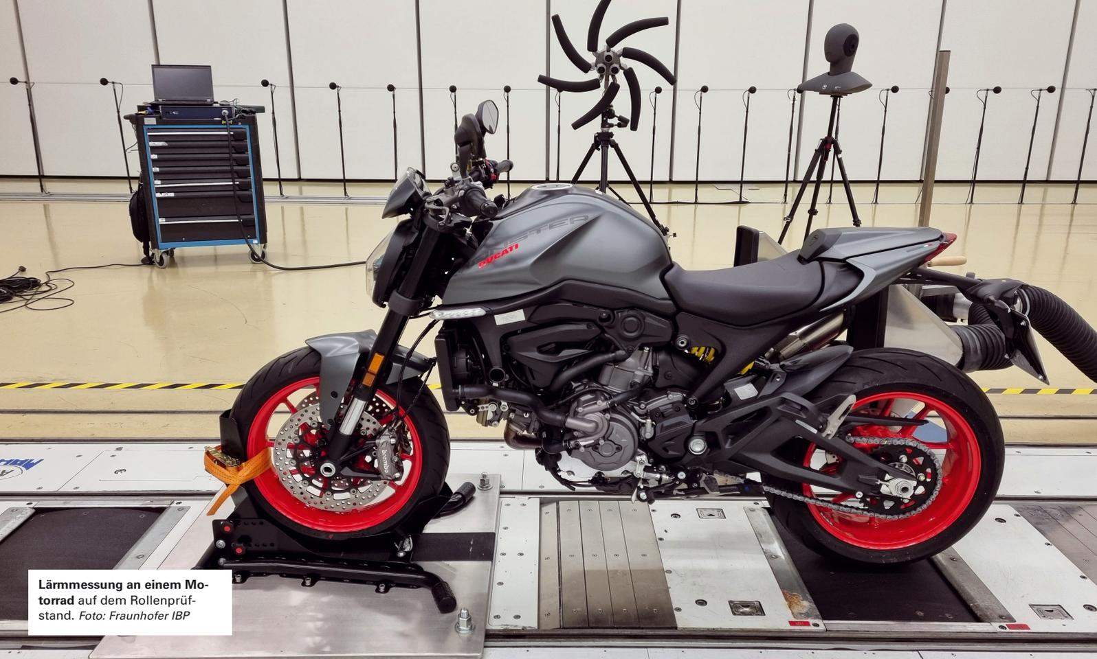
Lärmmessung an einem Motorrad auf dem Rollenprüfstand. Foto: Fraunhofer IBP
