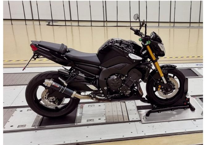
**Bild 1** Geräuschmessung im Akustik-Rollenprüfstand des Fraunhofer IBP mit Mikrofonarray im Hintergrund (links) und Fixierung des Motorrads auf dem Prüfstand (rechts). Fotos: Fraunhofer IBP
