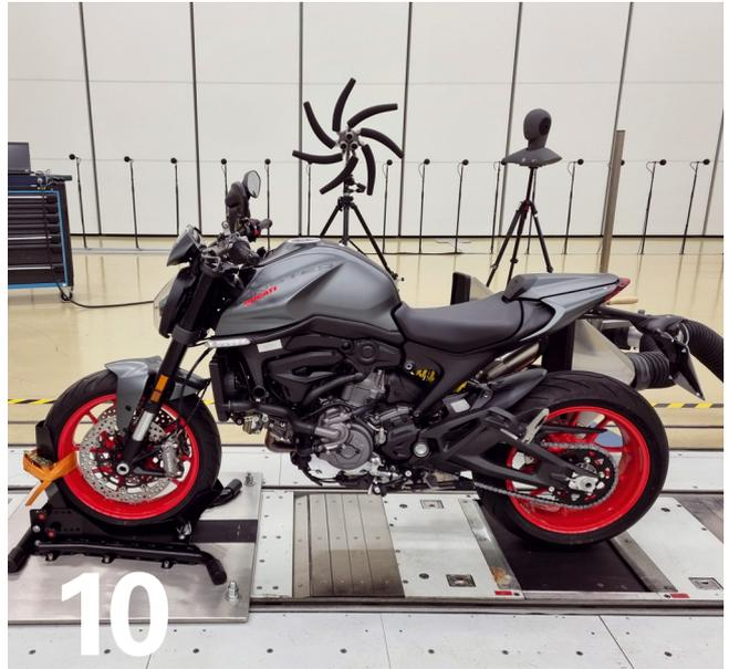
**Lärmmessung an einem Motorrad** auf dem Rollenprüfstand. Für die Zulassung werden die Pegelangaben zum Standgeräusch und zur Vorbeifahrt erfasst. Foto: Fraunhofer IBP
