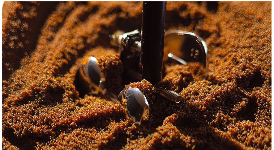
Mit trockenem Elektropolieren lassen sich Oberflächen wie hier von Implantaten reproduzierbar und ressourcenschonend in kurzen Prozesszeiten auf Hochglanz polieren. Foto: GPA Innova
