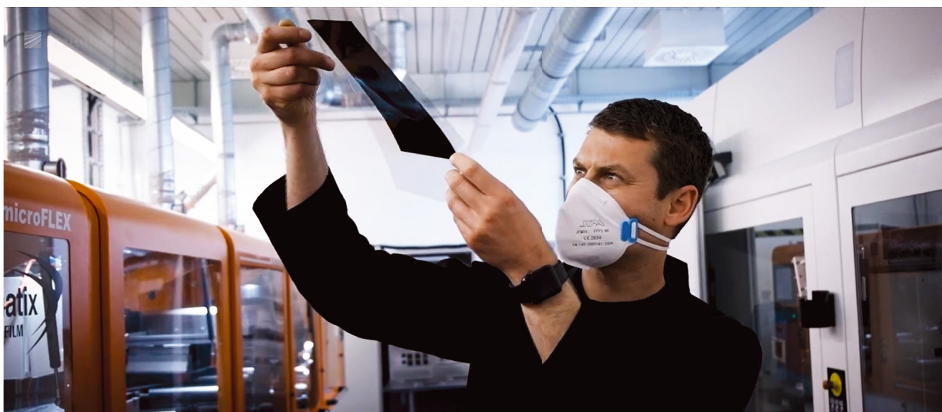
CCM/MEA, hergestellt im Inkjet-Druckverfahren. Foto: Fraunhofer ENAS
