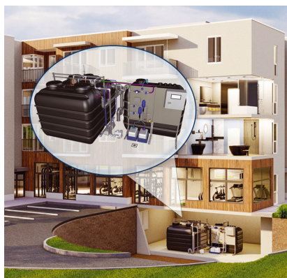
In Mehrfamilienhäusern bietet es sich an, Grauwasserreinigungsanlagen in Kellern zu installieren. Grafik: Intewa
