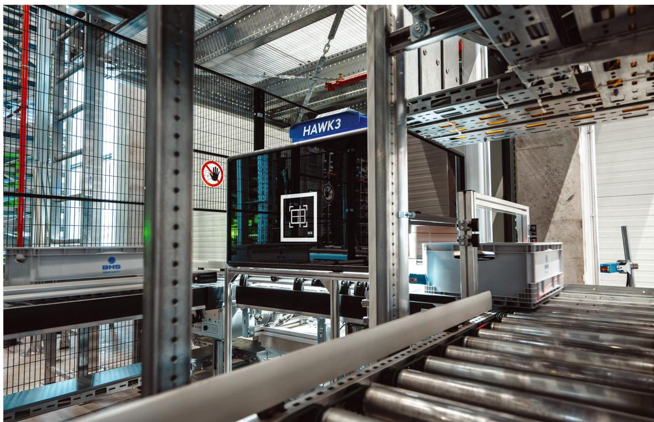
**Bild 2** HAWK ermöglicht eine vollumfängliche Inhaltskontrolle von bewegten Behältern auf der Fördertechnik, erkennt Anomalien auf Basis von KI. Foto: IGZ
