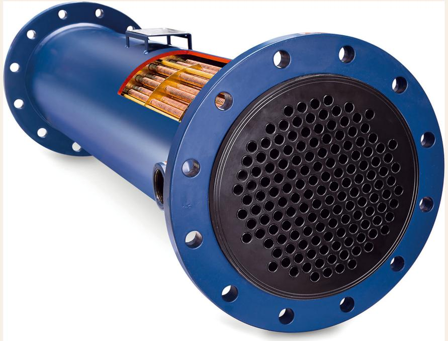
**Bild 3.** Rohrbündelwärmetauscher: Darüber kann ein Großteil der für die Druckluftherzeugung aufgewandten elektrischen Energie zurückgewonnen werden. Grafik: Aerzen
