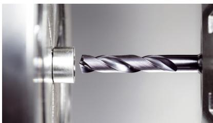
**Bild 2.** Bohren des Schraubenkopfes mit dem System „DD“. Foto: Horn/Sauermann
