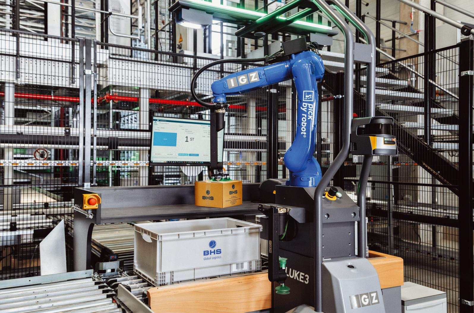
Bild 1 Der Kommissionierroboter LUKE3 unterstützt die Mitarbeitenden von BHS Global Logistics zuverlässig bei der Einzelstückkommissionierung. Foto: IGZ
