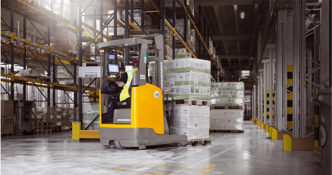
**Bild 3** Dank Lithium-Ionen-Technologie ist die Performance der Fahrzeuge höher. Die Batterien sind zudem wartungsarm und haben eine höhere Lebensdauer als Blei-Säure-Batterien. Foto: Jungheinrich
