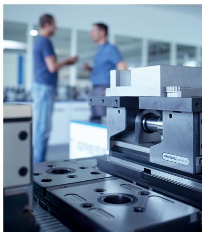
**Bild 2.** Das Leistungsportfolio umfasst einen durchgängigen Baukasten an Werkstück-Spanntechnik bis hin zu automatisierten Komplettlösungen für die Einzelteil- bis Großserien-Fertigung. Foto: Gressel
