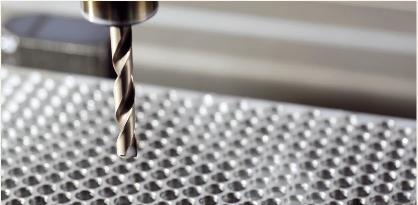
**Bild 1.** Ein unbeschichteter Bohrer schafft 28 Löcher, mit einer passenden Beschichtung sind es über 4500. Die 160-fache Lebensdauerverlängerung spart 13,7 kg des kostbaren Hartmetalls ein. Foto: Oerlikon
