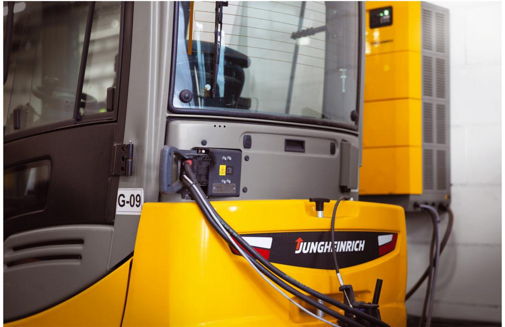
**Bild 4** Dezentrales Schnell- und Zwischenladen sichert den permanenten Fahrzeugeinsatz im Dreischichtbetrieb.
