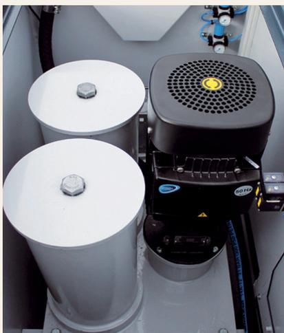
**Die Kleinanlage** hat eine maximale Filterleistung von 70 l/min und stellt über einen langen Zeitraum sauberes Öl in NAS 9-Qualität zur Verfügung. Foto: Vomat
