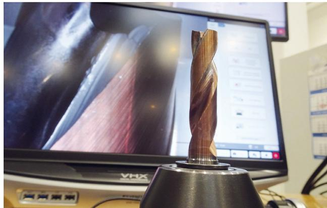
**Bild 2.** Der Flachbohrer „FD“ wurde in drei Korrekturschleifen für seine Aufgabe optimiert. Die Vergrößerung zeigt auch nach hartem Einsatz kaum Verschleiß an den Schneiden. Foto: Etmanski
