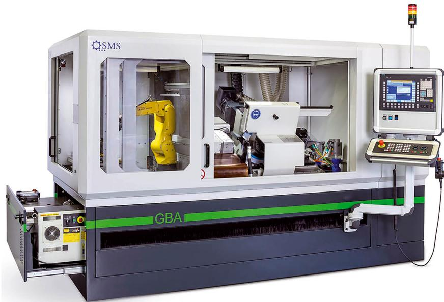
**Bild 1.** Das Unternehmen baut eigene Maschinen und rüstet ältere Maschinen im Retrofit-Verfahren mit moderner CNC-Technik nach. Foto: SMS Maschinenbau
