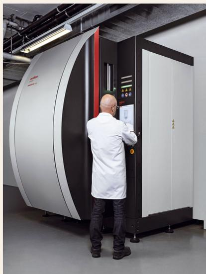
**Bild 2.** Der Ressourceneinsatz bei der PVD-Beschichtung in solchen Anlagen beträgt nur etwa 10% im Vergleich zur Herstellung eines Hartmetallwerkzeugs. Foto: Oerlikon
