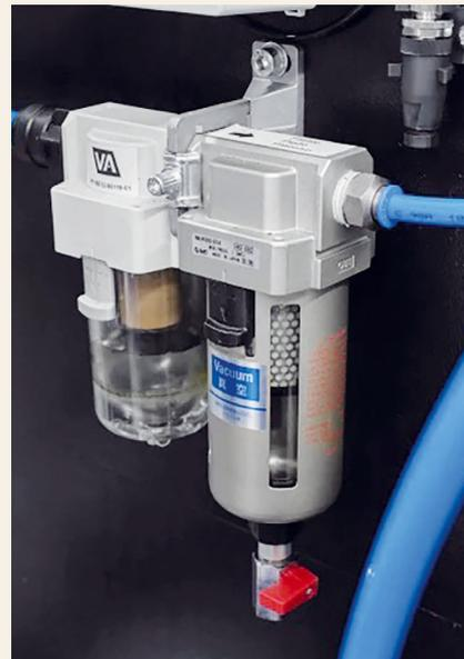
**Bild 4.** Das Vakuum-Filtersystem mit Flüssigkeitsabscheider und einem Druckwächter mit Sensor ist extrem feinfühlig. Foto: AMF
